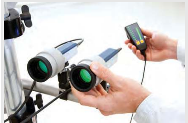
MPV-A-830 反射信号电平显示，便于激光点达最佳聚焦
