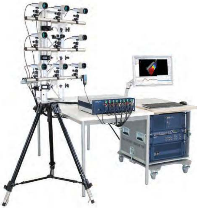
MPV-800基本测量系统带有8个光纤头
